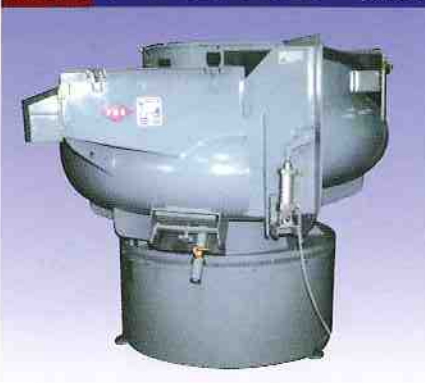
AG型 ゲートをエアシリンダーで開閉
