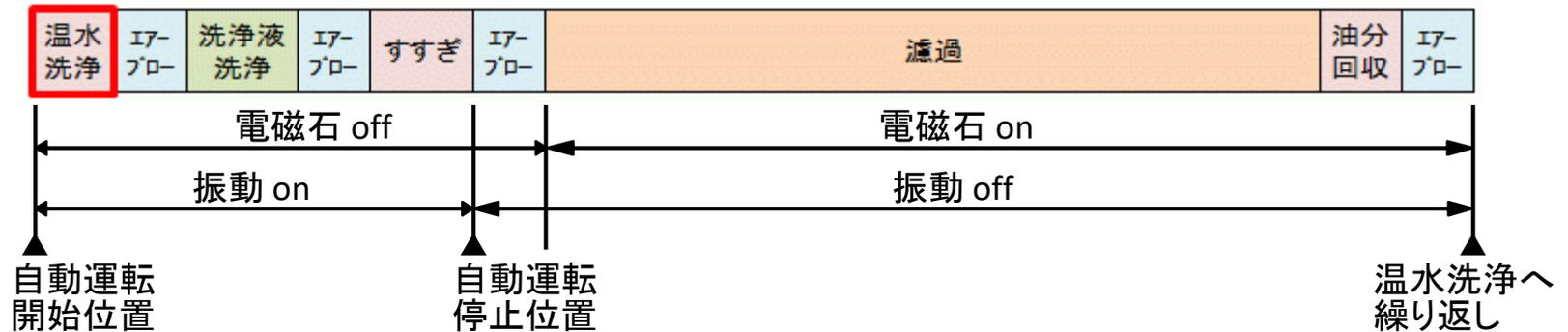
HIGAMSは、圧延油中の混入鉄粉を内部鉄球に吸着させる**濾過工程**と、濾過筒を振動させながら洗淨液を通液して鉄球から鉄粉を洗い落とす**洗淨工程**を自動的に繰り返しますので、長期間高い除鉄効率を維持することができます。各々の工程時間はタイマーにより設定できます。
